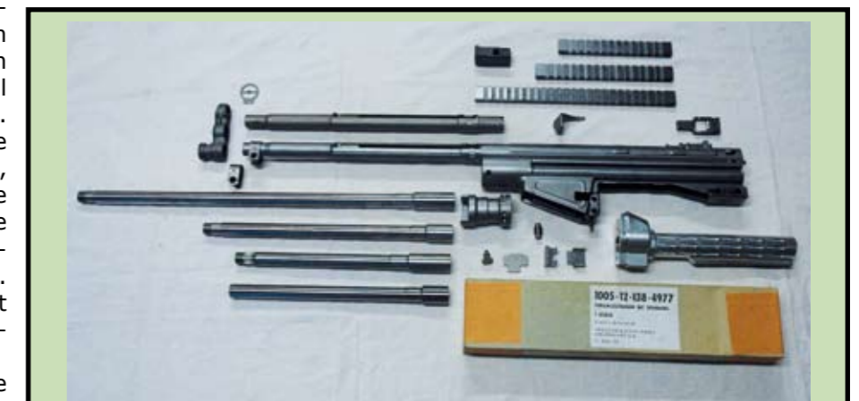
Weissfertige HK-Originalteile, wie sie in der Fertigung des M41 Verwendung finden. Hülsenabweiser, verschiedene Korne, M1913-Schienen sowie Lothar-Walther Matchläufe verschiedener Länge sind einige der vielen Optionen, die man bei der Waffe wählen kann. Die Gehäuse werden standardmässig manganphosphatiert. Die Firma legt besonderen Wert darauf, hauptsächlich HK-Originalteile zu verbauen ( www.schwabenarmsgmbh.de ).
