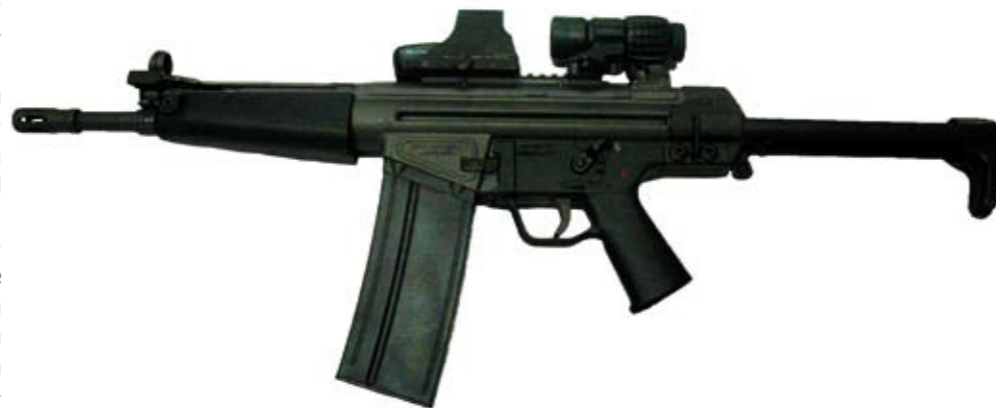
Oben: SAR M41 Offizier mit einem EOTech-Reflexvisier und zusätzlich vergrößernder Optik von Aimpoint. Lauf: 265mm, Ø 17mm kaltgeschmiedeter und im Vakuum Spannungsfrei geglühtes Polygonrohr (ca. 30% mehr Gasdruck), Lothar Walther-Matchlauf, freischwingend. Verschluss: Halbstarrer Rollenverschluss. System: Rückstoßlader. Zum Vergleich: Das dienstliche HK G36 ist ein Gasdrucklader mit Drehkopverschluss mit sechs Verriegelungswarzen.
