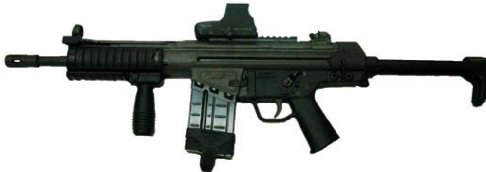
Oben: SAR M41 Offizier mit Montageschiene, Vordergriff, 20-Schuss-Magazin, Magpul-Extrahierer, EOTech 551 und einschiebbarer Schulterstütze, wie ihn auch die Fallschirmjäger der Bundeswehr hatten. Angeblich schlummern noch bis 16.000 HK G3 in den Depots der Bundeswehr und warten auf ihre taktische Verwendung in der Truppe, die zunehmend wieder „En vogue“ sind.
