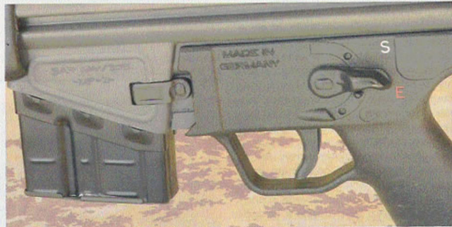
L'impugnatura in polimeri con la leva del selettore limitata a due sole posizioni. La modifica dell'innesto dell'impugnatura al castello ha comportato l'eliminazione dello sgancio a bilanciere del serbatoio, è rimasto quindi solo quello a pulsante.
