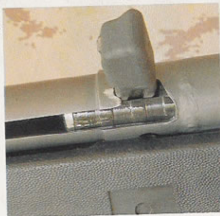
La scanalatura per il passaggio della manetta di armamento è dotata di una tacca posteriore che consente di bloccare l'otturatore in apertura.
